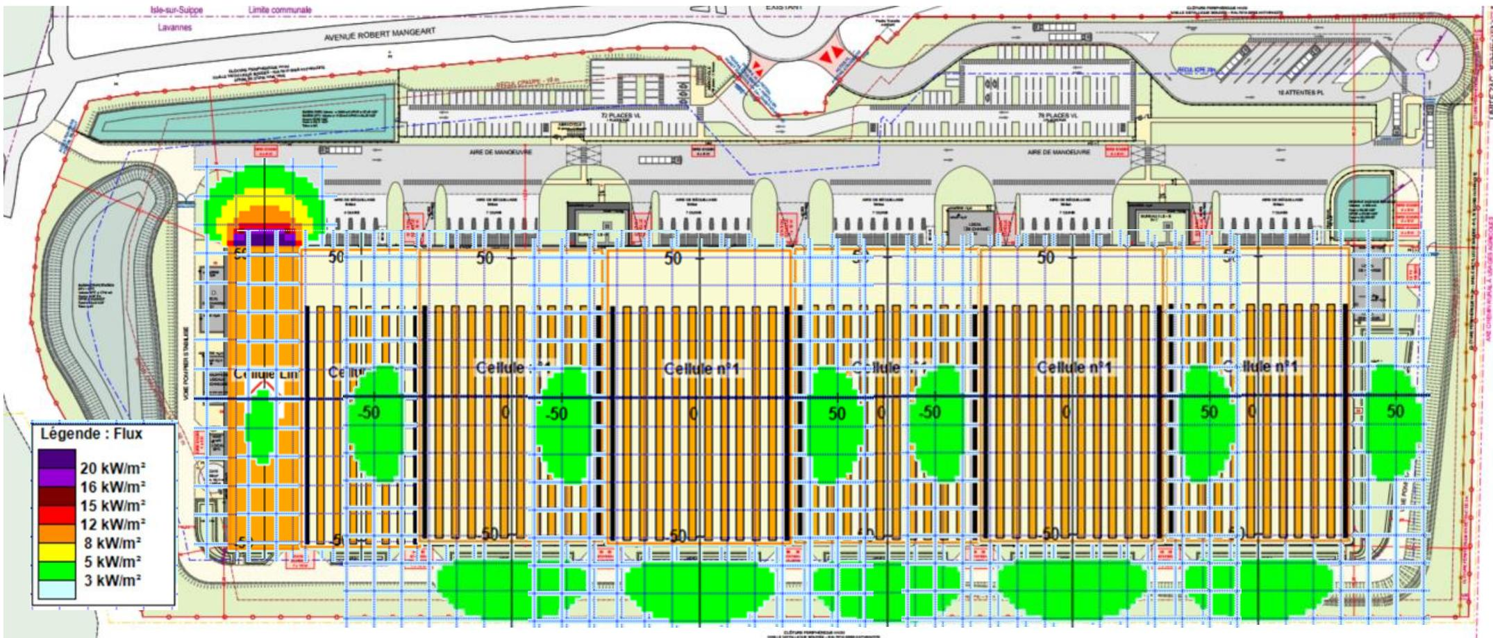
Plan des flux thermiques
